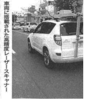
車両に搭載された高精度レーザーキャナー
